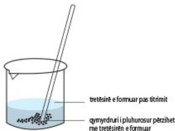
Marrja e ngjyrës së indikatorit nga tretësira me shtimin e qymydrurit të pluhurosur në tretësirën e formuar. Ky është kusht që të mund të ndahet kripa e fituar pas reaksionit.
