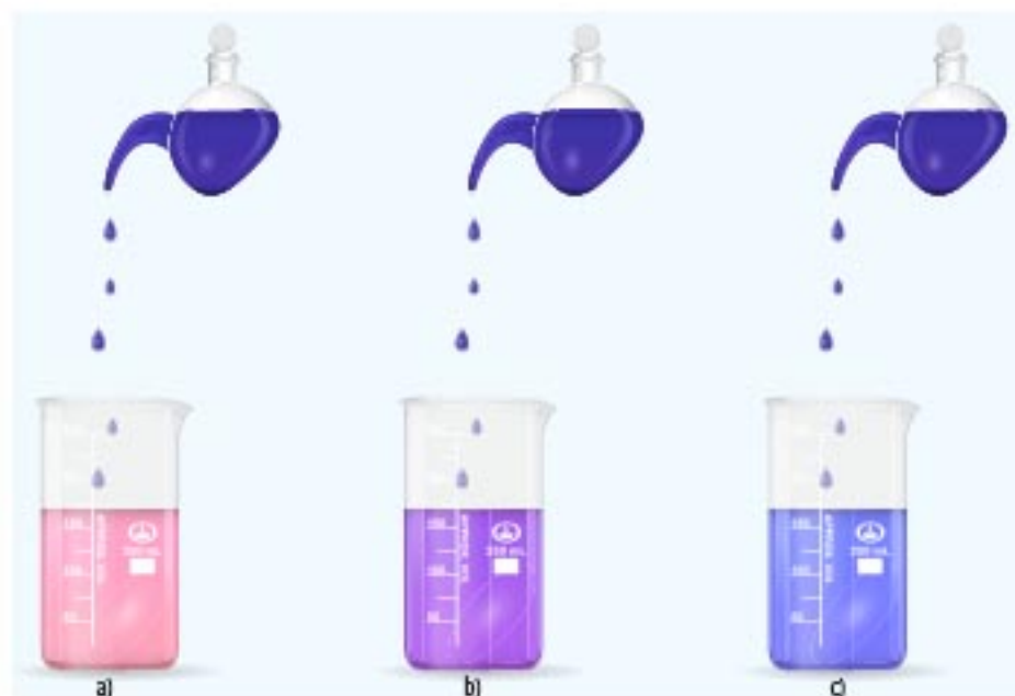
Lakmusi e ndryshon ngjyrën në varshmeri nga aciditeti i mjedisit: e kuqe në vjollcë në acidike (a), vjollcë në neutrale (b) dhe e kaltër e errët në mjedis bazik (c).
