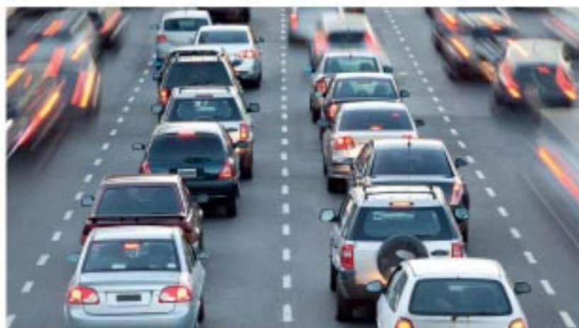
Automjetet lëshojnë ndotës të ndryshëm në ajër. Konvertorët katalitik (pasi të ngrohen) në sistemet lëshuese mund të jenë të dobishëm. Ato e shndërrojnë monoksid karbonin në dioksid karbon, oksidet e azotit në azot, ndërsa hidrokarburet e padjegura në dioksid karboni dhe ujë.
