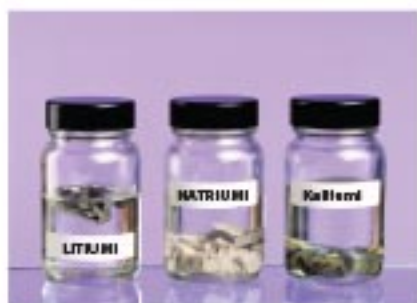
Metalet alkaline ruhen në vaj për shkak të reaktivitetit të madh të tyre.
